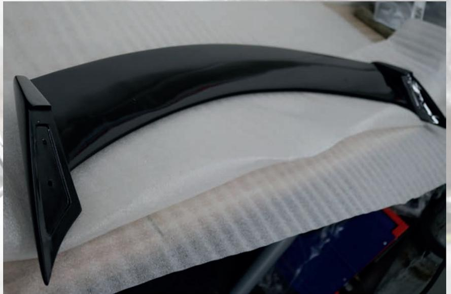
2. Anlagefläche des Dachspoilers beidseitig bis auf das GFK abschleifen (siehe Bild)
