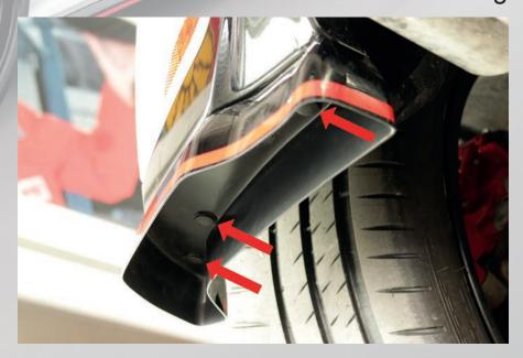
5. Verschrauben Sie das Mittelteil des Heckdiffusors mit Hilfe der mitgelieferten Schrauben an der Heckschürze
